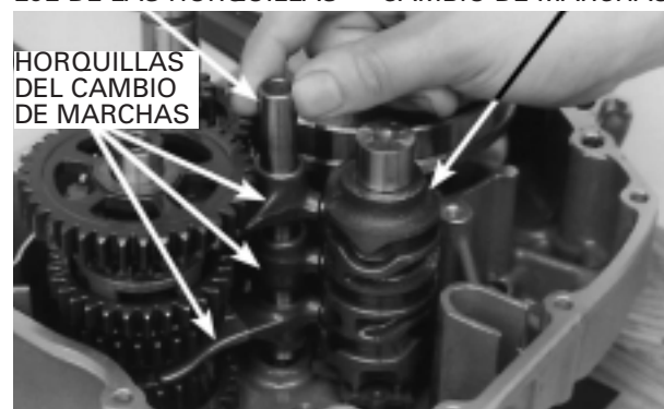
EJE DE LAS HORQUILLAS TAMBOR DE CAMBIO DE MARCHAS
