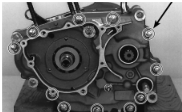
PERNO DE LA MITAD DERECHA DE LA CARCASA DEL MOTOR PERNO DE LA CARCASA DEL MOTOR
